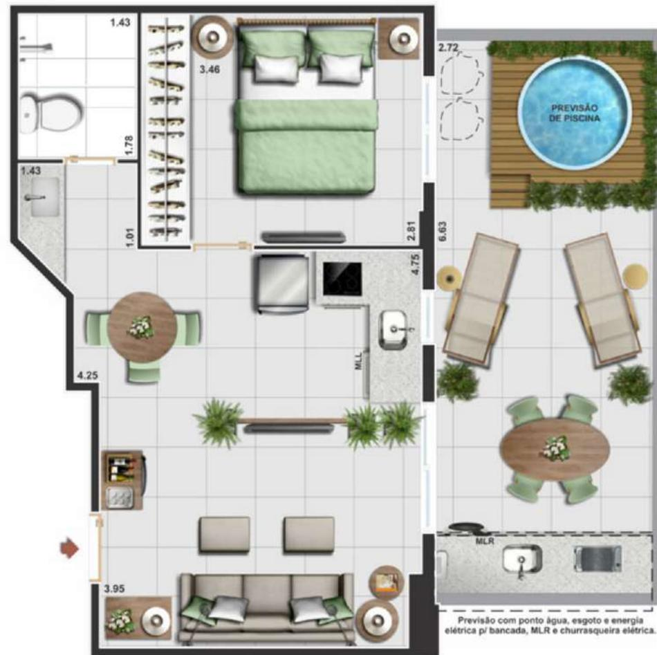
Previsão com ponto água, esgoto e energia elétrica p/ bancada, MLR e churrasqueira elétrica.
